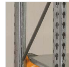
Stabilitást biztosító merevítő elem
